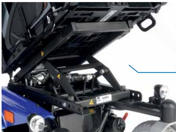
Modulo elettronico per il basculamento (da 0° a 30°) con regolazione del centro di gravità per adattarsi al corretto punto d'equilibrio dell'utente opzionale.
